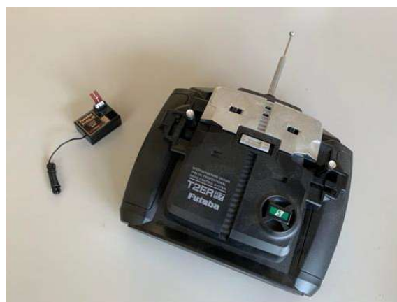
市售 3 通道 27MHz 板型遙控收發器
